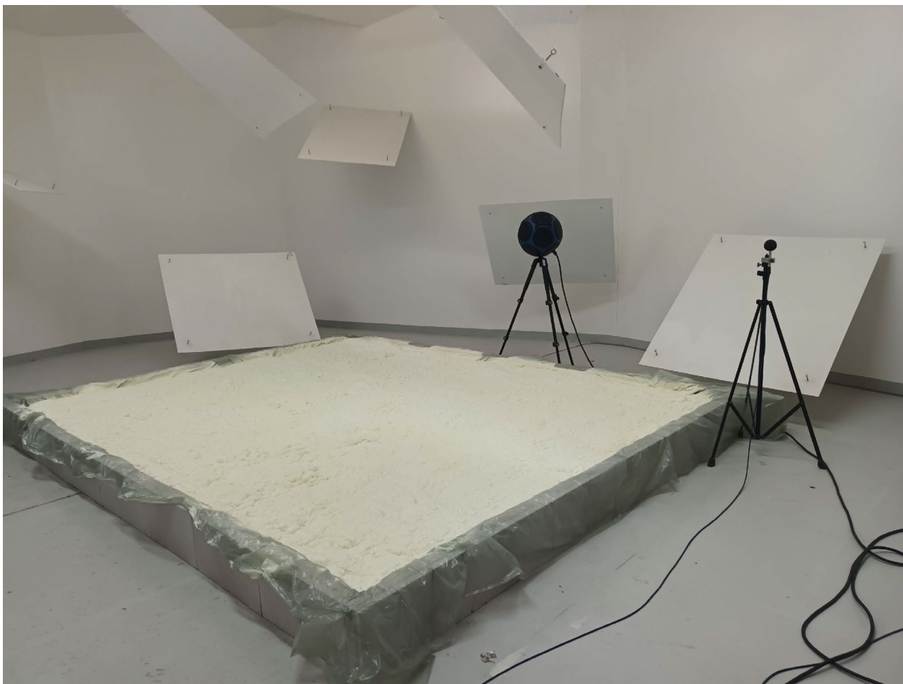
Obr. č. 2 Vzorek instalovaný v dozvukové komoře
